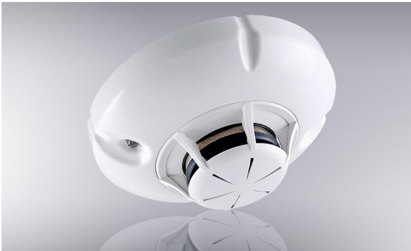
O detector de incêndio FD8060 fornece um aviso atempado de incêndio, reagindo à concentração de emissões de fumo ou à subida de temperatura ou limiar fixo definido. Combinando as vantagens dos detectores FD8020 e 8030, constitui uma opção atractiva devido às diminutas despesas de fornecimento e instalação.
