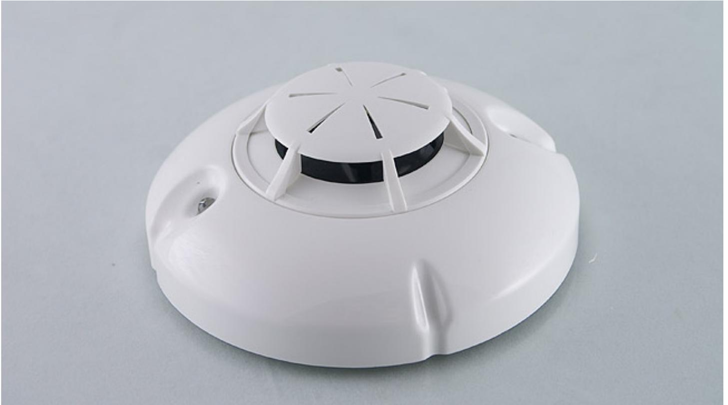
O FD8020 é um detector termovelocimétrico concebido de forma a fornecer um aviso atempado da condição de incêndio, com ou sem emissão de fumo, reagindo perante uma taxa sensível de elevação de temperatura ou quando a temperatura ambiente atinge um patamar pré-definido.
